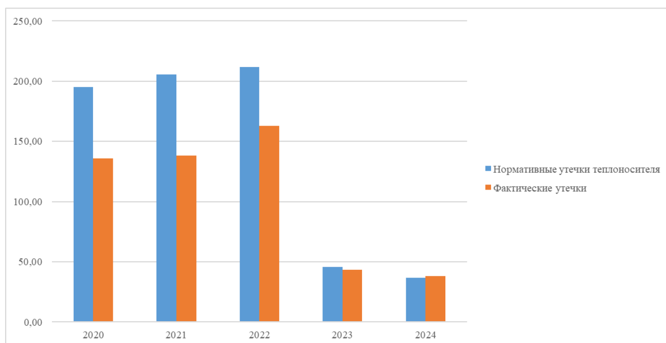
Рисунок 7.1 – Утечки из тепловых сетей
